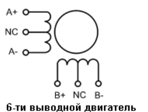
6-ти выводной двигатель максимальный вращающий момент
