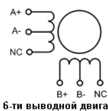
6-ти выводной двигатель, максимальная скорость, пониженный вращающий момент
